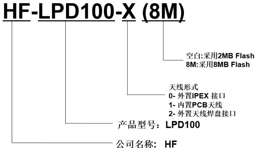
Figure 11. HF-LPD100 产品编号定义
