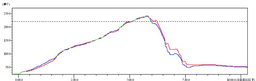
Figure 46. 回流焊焊接温度曲线图
