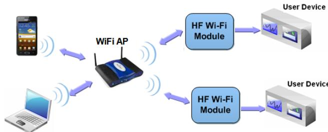
Figure 14. 基本的 HF-LPD100 无线组网结构
