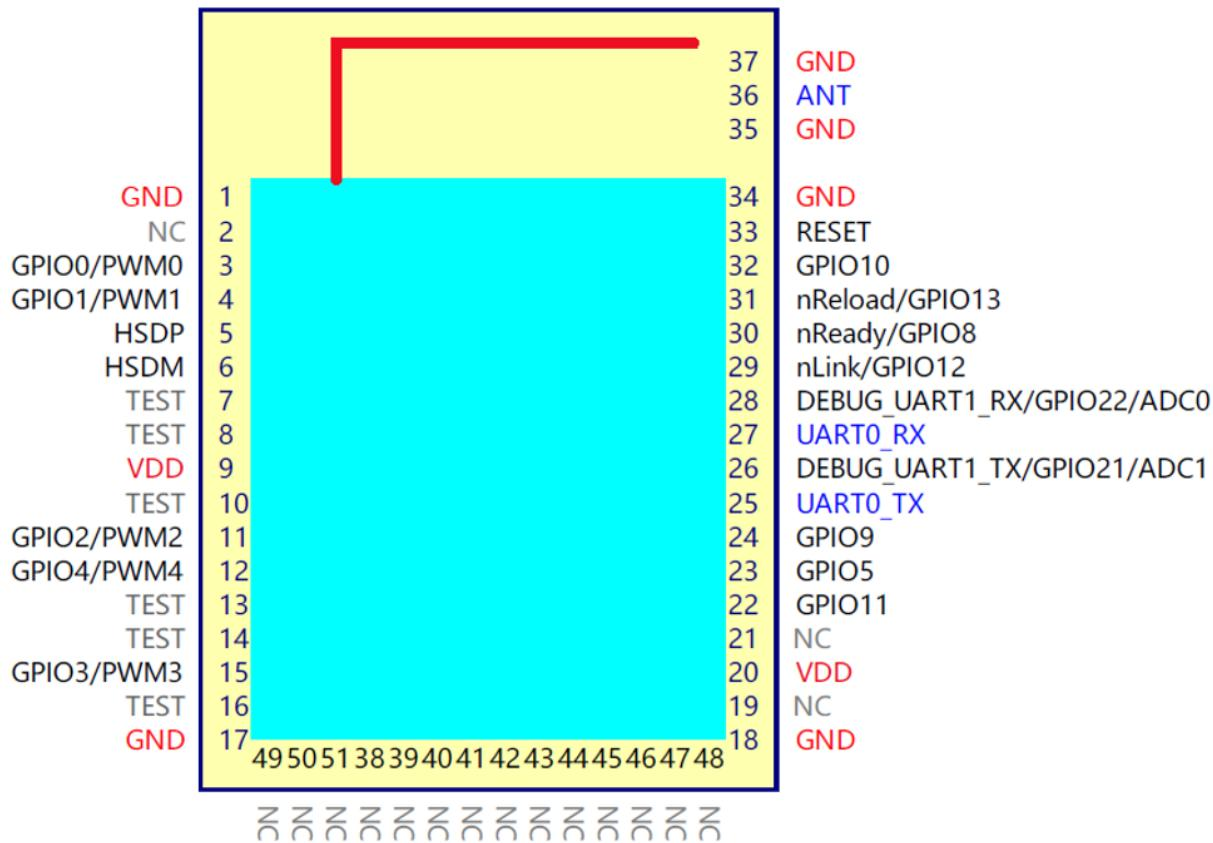
Figure 4. HF-LPD100 管脚定义
