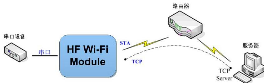
Figure 15. HF-LPD100 的 AP+STA 组网结构
