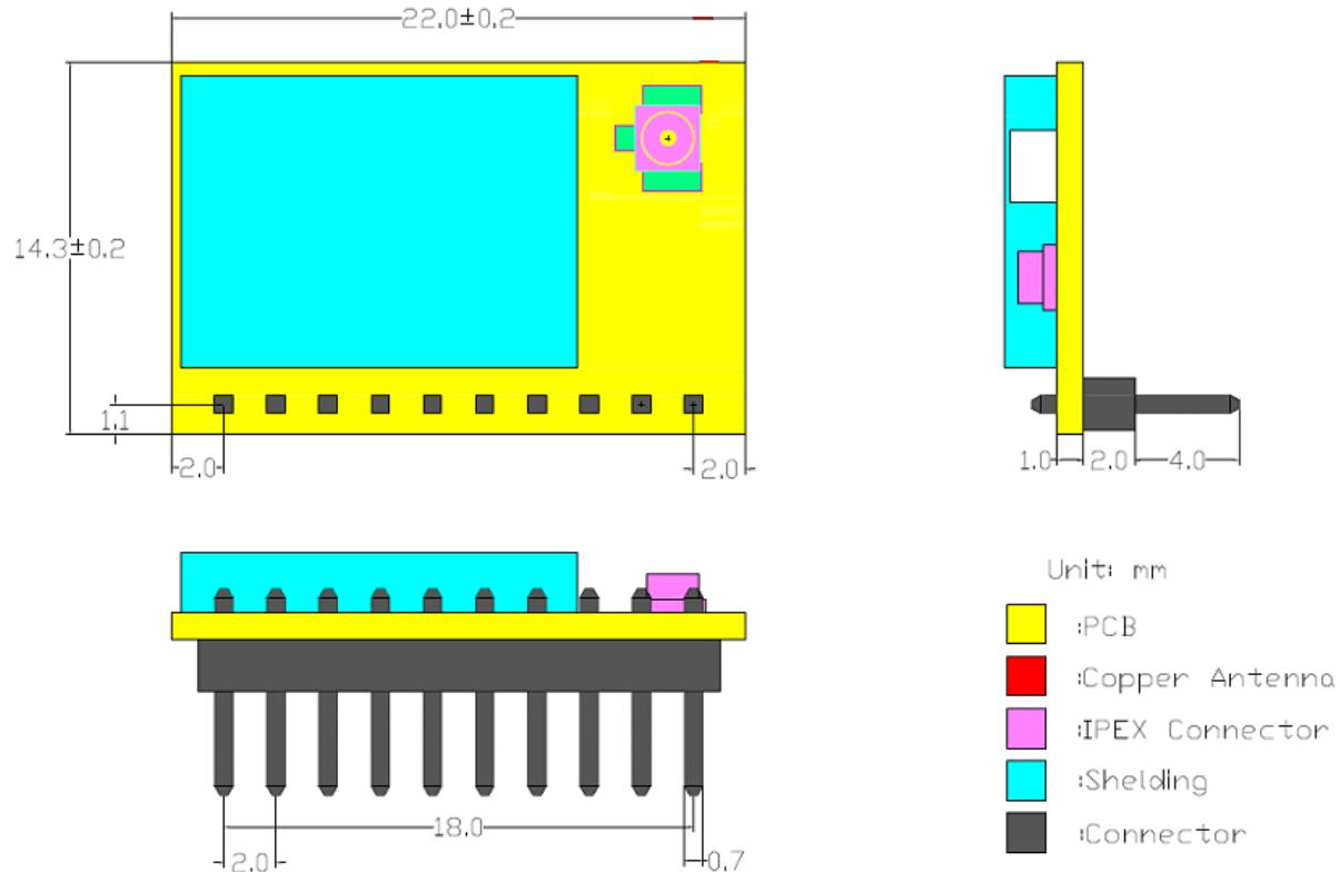
Figure 8. HF-LPD130 机械尺寸
