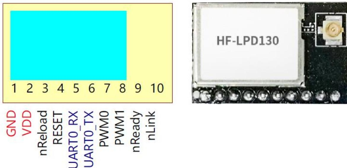
Figure 5. HF-LPD130 管脚定义
