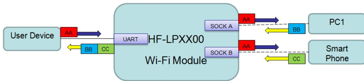
Figure 17. 双 Socket 数据流向示意图
