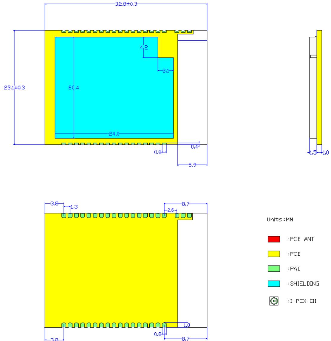
Figure 7. HF-LPD100-2 机械尺寸
