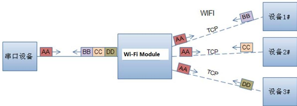
Figure 18. 多 TCP 链接数据传输图示
