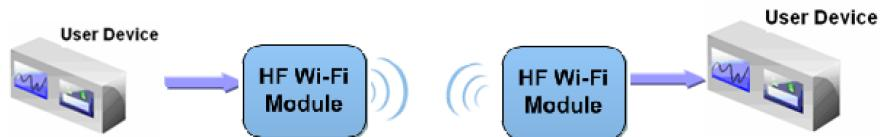
Figure 42. 透明串口应用图示
