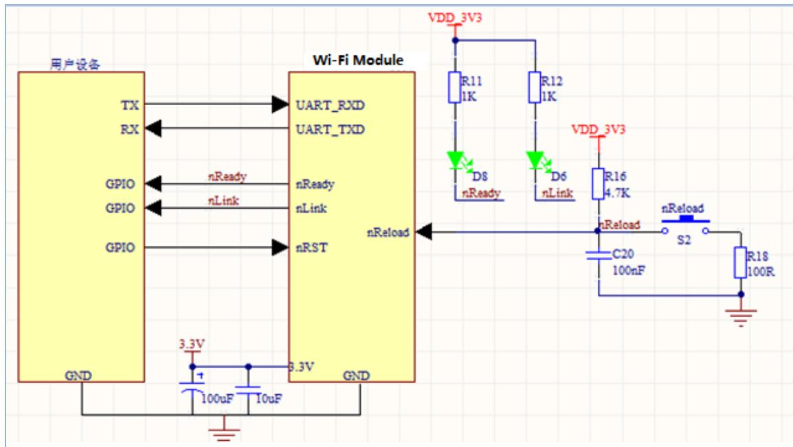
Figure 13. HF-LPD100 UART 应用硬件连接
