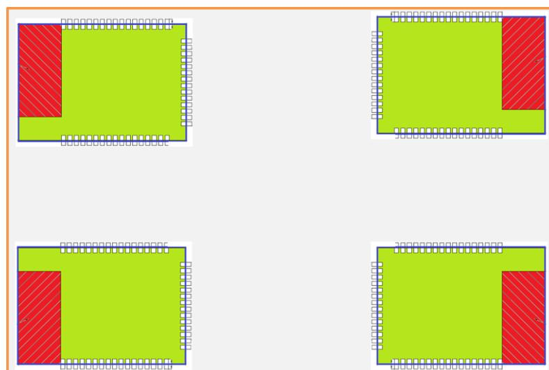
Figure 9. HF-LPD100 模组建议放置区域
