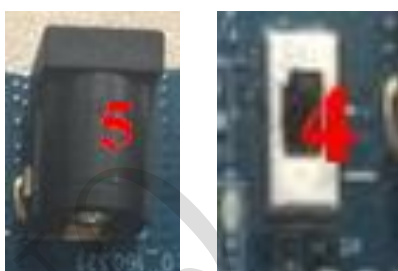
图 3 L306 开发板 DC 供电及开关
