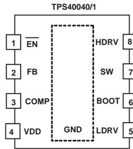
Figure 17. DRB Package Terminal Configuration (Top View)
