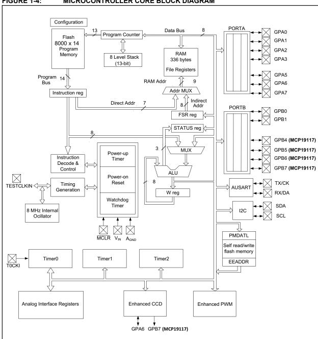
FIGURE 1-4: MICROCONTROLLER CORE BLOCK DIAGRAM
