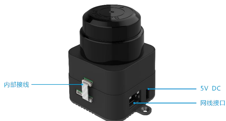
图表 2-5 SLAMTEC Mapper 母座接口定义示意图
