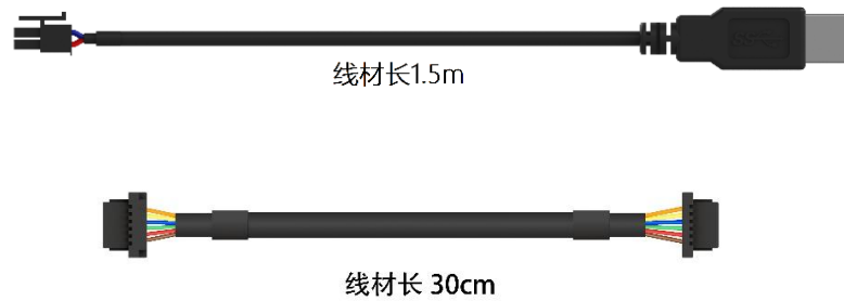
图表 2-6 SLAMTEC Mapper 配线示意图
