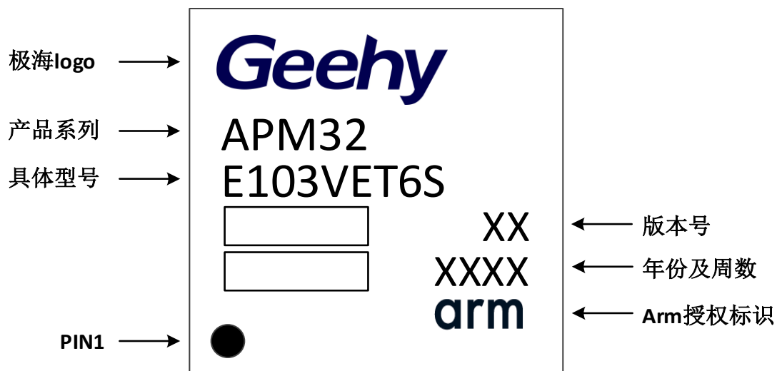
图 16 LQFP100 - 100 引脚, 14 x 14mm 封装标识
