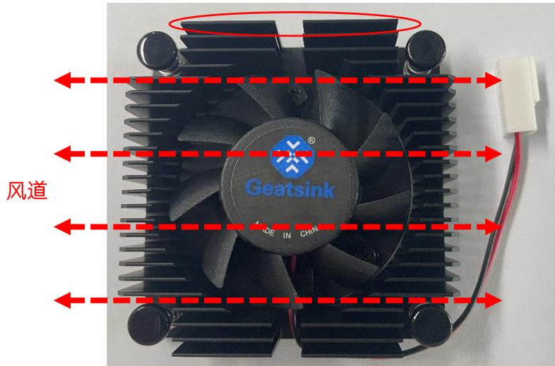
结合飞腾派器件布局情况，CPU 散热风扇风道应保持左右向（长边方向）。
